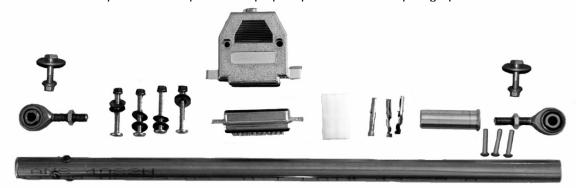
Quand le servo doit être relié à un système de contrôle d'aileron qui est actionné par des câbles, le kit d'installation montré ci-dessous sera fourni. Une tige pousseuse plus courte est incluse. La bride qui est attachée à la tige pousseuse sera placée autour du câble et solidement serrée.
